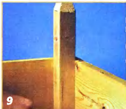
9 Чтобы разметить вырезы в днище под колышки, раму переворачивают и кладут на плиту днища.
