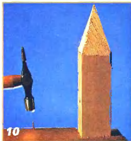
Чтобы днище точнее подогнать к боковым стенкам, вырезы под колышки возможно придется несколько подправить.
