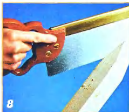
8 Колышки заостряют по линиям, предварительно размеченным на всех четырех гранях.
