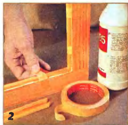
При вклеивании упорные штапики для стекол фиксируют клеевой лентой.
