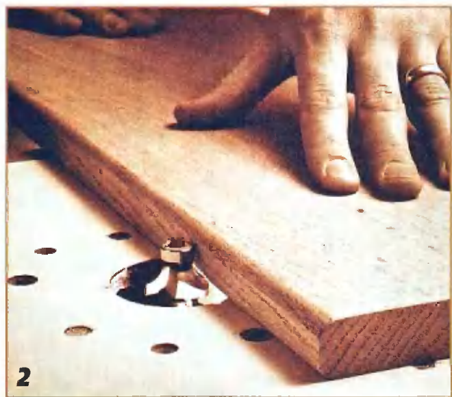
Продольную боковую кромку доски фрезеруют фасонной фрезой с минимальной подачей, чтобы на обработанной поверхности не оставалось сколов и подрывов волокон древесины.
